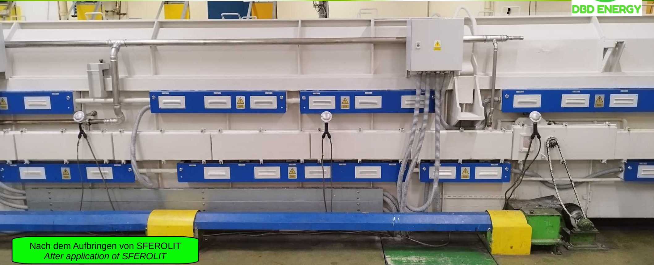
Ansicht des Härteofens nach dem Auftragen von 4 Schichten insg. ca. 3mm Schichtdicke Hardening furnace view after application of SFEROLIT, 4 layers – coating thickness ~3 mm
